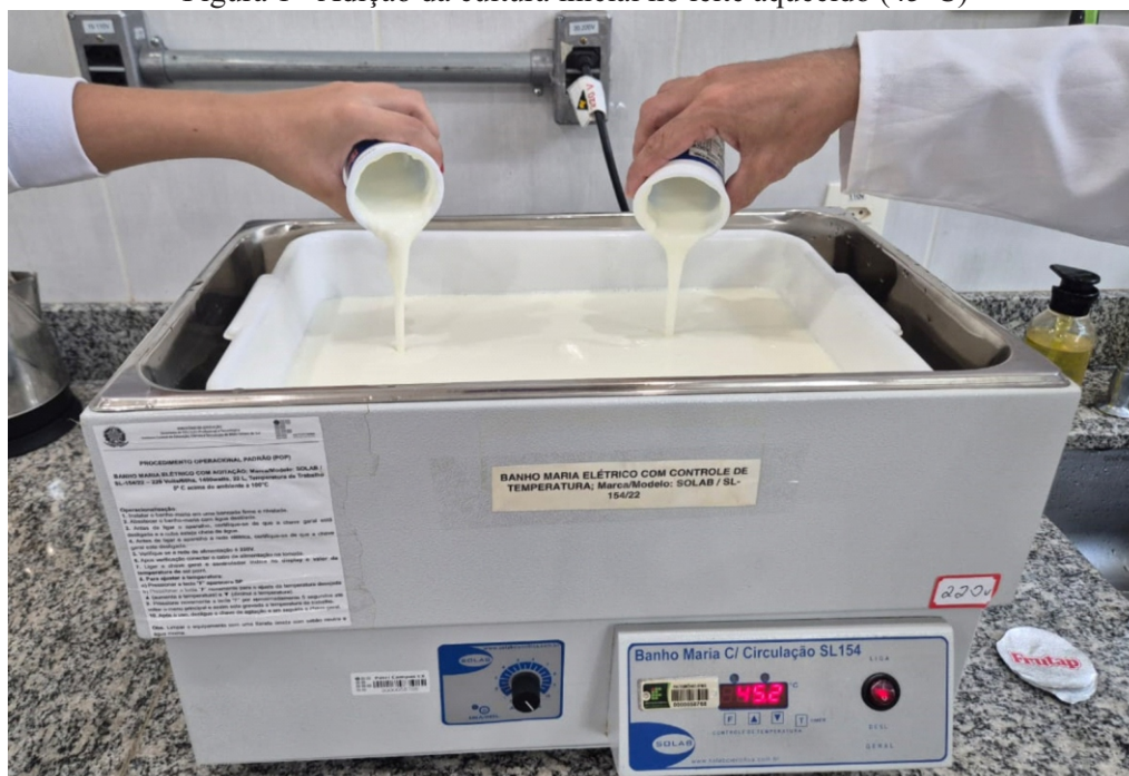
Figura 1 - Adição da cultura inicial no leite aquecido (45°C)
