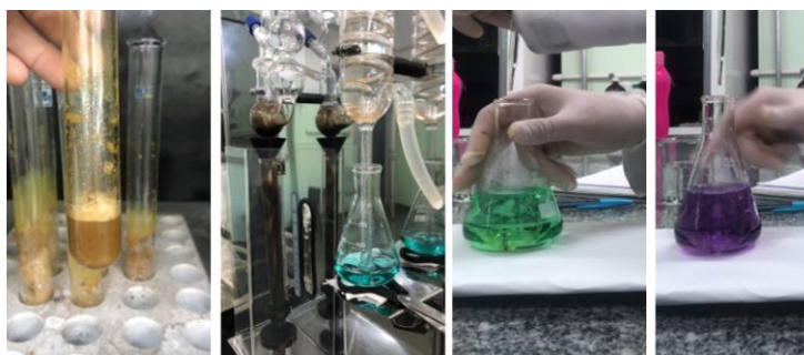
Figura 5 - Determinação de proteína pelo método Kjeldahl, na sequência: (1) Digestão da amostra com ácido sulfúrico, (2) Destilação, (3) Antes da titulação, (4) Depois da titulação com HCl.
