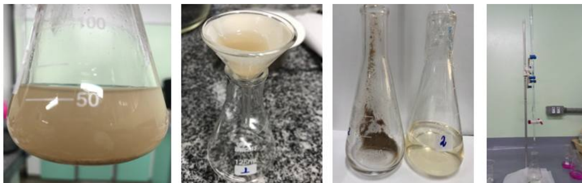
Figura 2 - Etapas da titulação para determinação do índice de acidez nas amostras de FCO e RC, na sequência: (1) Descanso da amostra com álcool etílico PA, (2) Filtragem com papel filtro (3) Amostra pós-filtração, (4) Titulação das amostras com solução de NaOH.
