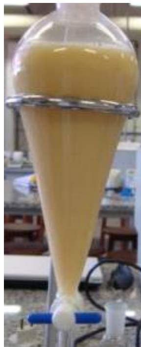
Figura 7 – Formação da Emulsão após a Transesterificação do Sebo Purificado com CaOCC
