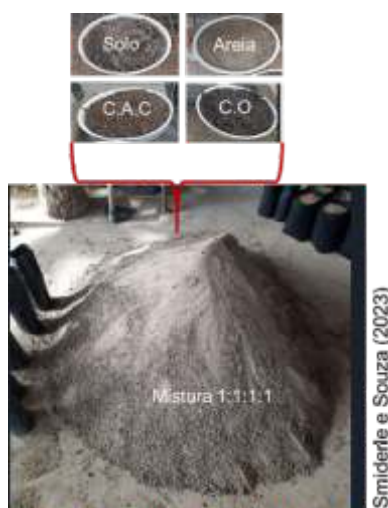
Figura 1- Visualização do preparo da mistura de substrato contendo 25% de areia + 25% de terra virgem + 25% de casca de arroz carbonizada + 25% de composto orgânico (v/v 1:1:1:1) no galpão da Embrapa - RR.
