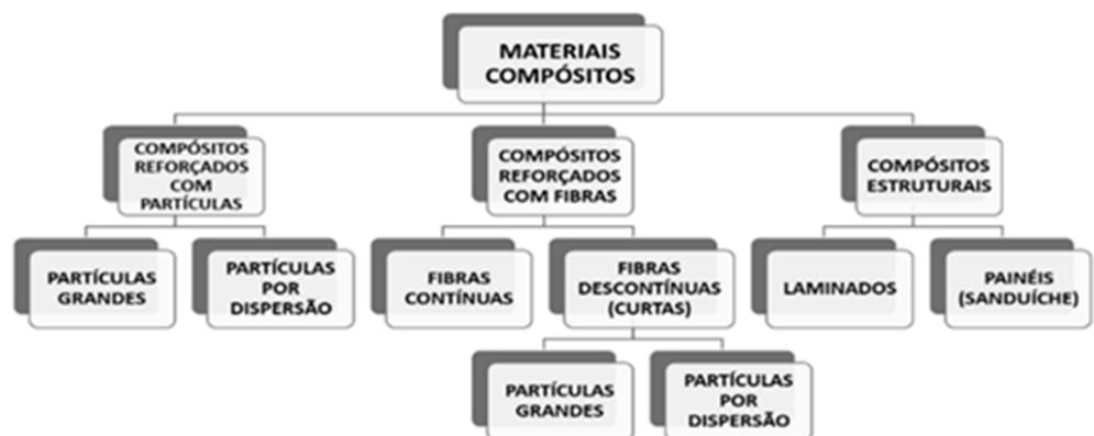
Figura 4. Classificação dos tipos de fibras [23]
