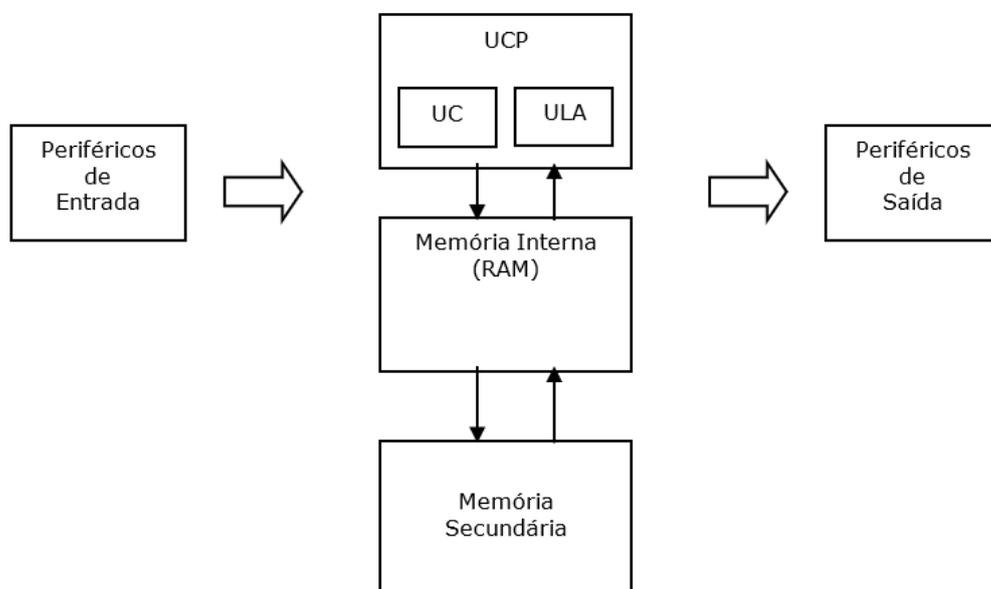
Figura 2 – Esquema Básico de Funcionamento do Computador de acordo com a Arquitetura de Von Neumann
