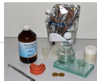
Fig. 74 - Pó, líquido, dispensador em volume, potes, placa de vidro, espátulas e separadores (moedas).
