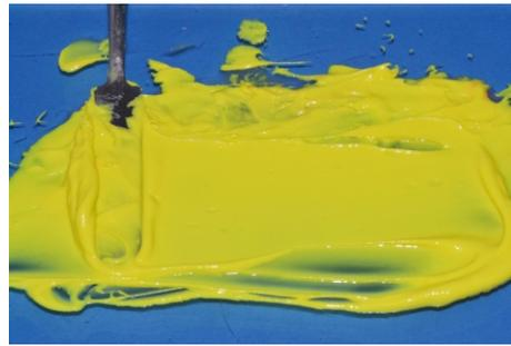
Fig. 67 - Espatular garantindo a obtenção de uma mistura homogênea.
